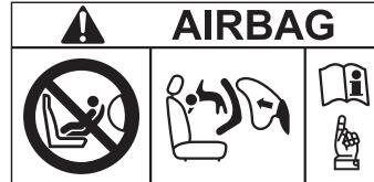
Et bakovervendt barnesikringssystem må ALDRI brukes i et sete som er beskyttet med en AKTIV KOLLISJONSPUTE foran. Dette kan forårsake DØD eller ALVORLIGE SKADER hos BARNET.
