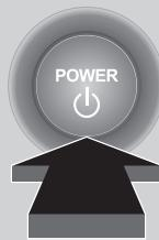
Hvis du har med deg den nøkkelfrie fjernkontrollen og trykker på **POWER**-knappen uten å trå på bremsepedalen, endres effektmodus i denne rekkefølgen: KJØRETØY AV → TILBEHØR → PÅ → KJØRETØY AV.
