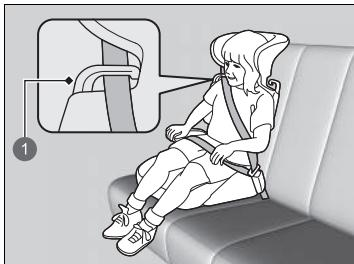
Det finnes en ryggstøtte for en bestemt sittepute. Monter ryggstøtten på sitteputen, og juster den i forhold til bilsetet i henhold til produsentens instruksjoner for sitteputen. Sørg for at sikkerhetsbeltet er ført korrekt gjennom føringen ved skulderen på seteryggen, og at beltet ikke berører eller krysser barnets hals.
