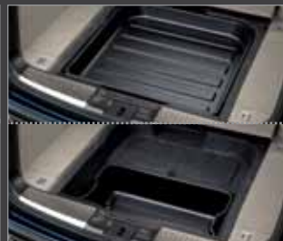
71 : Bagasjeromsboks oppe/nedi gulvet
