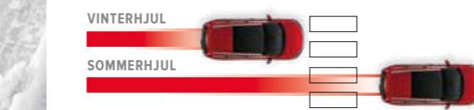
Bremse lengdene reduseres betydelig under vinterforhold. Originale vinterdekk kan forbedre bilens evne til å stoppe.
