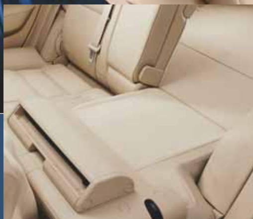
Setene felles opp når du trykker ned rygglenet. Baksetets ryggene danner et plant gulv, nakkestøttene får plass under det.
