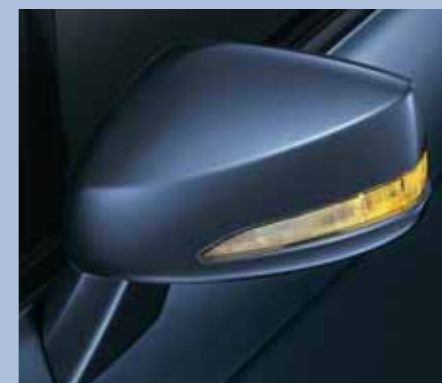
Blinklysene er plassert på de utvendige speilene, de synes tydelig og gir bedre aerodynamikk.
