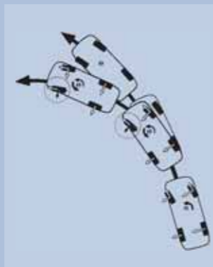
VSA kontrollerer understyring
