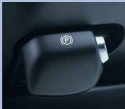
Håndbremsen, som smyer seg inn under instrumentpanelet, gir et plant gulv og større plass til bena.
