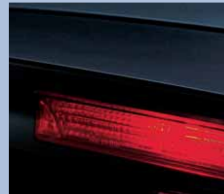
Det høyt plasserte bremselyset er diskret integrert i takspoileren.
